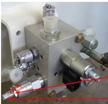
Рис 3: Регулировочный клапан
