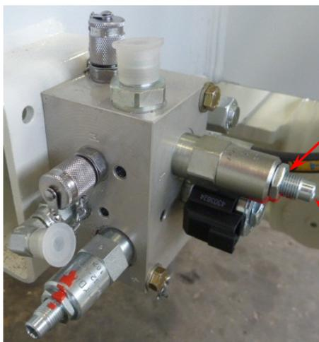
Рис 3: Регулировочный Винт клапана рабочего тормоза
