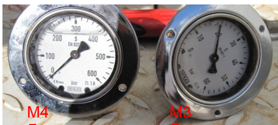
Рис 4: M4 (режим Черепаха), M3 (режим Кролик)
