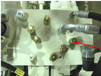
Рис 1: Порт контроля давления PPV
